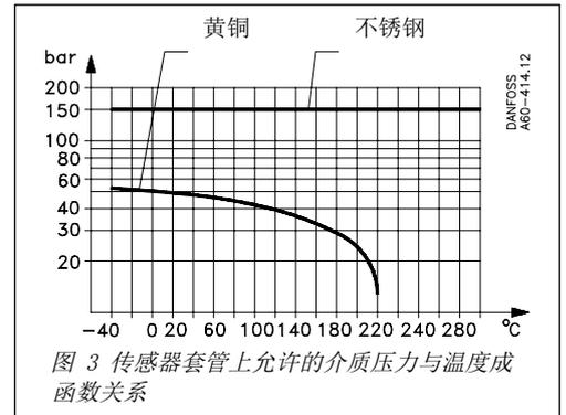
图 3 传感器套管上允许的介质压力与温度成函数关系
